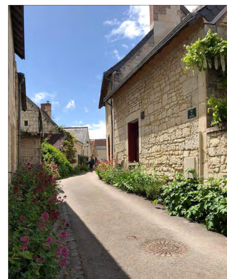
Canniveau abaissé sans bordure pour une simplification des abords de la voie. Massifs en pied de murs sans bordures pour une absorption des eaux pluviales
