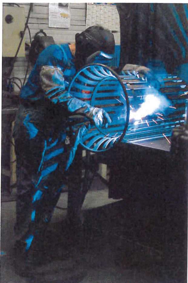
Portant un masque et des gants de protection, un ouvrier soudeur assemble les pièces d'une poubelle de rue.
